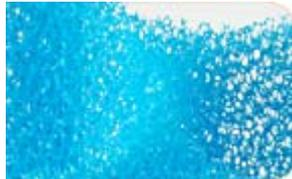
Filterschäume haben eine vollständig offene, gleichmässige Porenstruktur. Die Porengrösse ist mit PPI (Pores per linear inch) definiert. Lieferbar sind Filterschäume von 10 bis 80 PPI in zwei Materialqualitäten.
